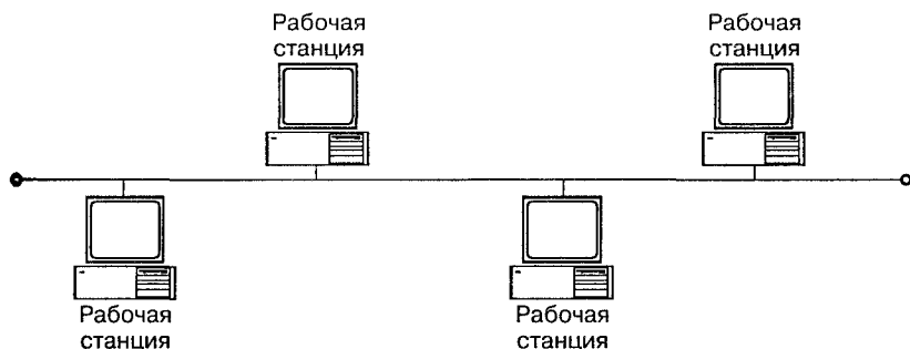
Рис. 8.2. Сеть с шинной топологией
