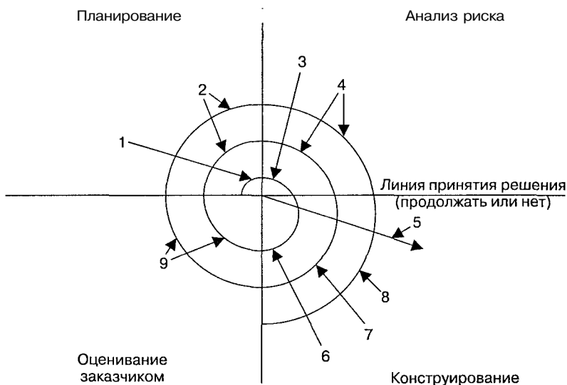
Рис. 12.4. Спиральная модель 1 : 1 — начальный сбор требований и планирование проекта; 2 — та же работа, но на основе рекомендаций заказчика; 3 — анализ риска на основе начальных требований; 4 — анализ риска на основе реакции заказчика; 5 — переход к комплексной системе; 6 — начальный макет системы; 7 — следующий уровень макета; 8 — сконструированная система; 9 — оценивание заказчиком
